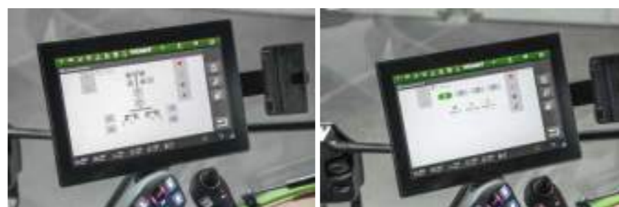
ISOBUS UT: bedieningsschermen kunnen op de trekkerterminal worden overgedragen ISOBUS AUX-N: overdracht op de rijkhendel mogelijk
