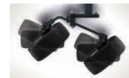
De als extra leverbare stuurbare tandemas van de Former 7850 maakt het mogelijk om ook in bochten de bodem optimaal te blijven volgen, en daarbij minder te schrappen en voor meer bescherming van de graszode.
