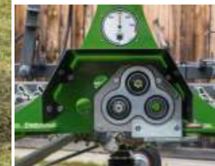
Universele transmissie van gegoten lichtmetaal, voor front- en achteraanbouw.
