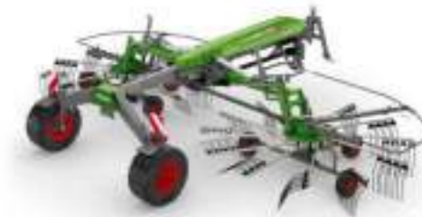
Midden zwadafleg met transportonderstel Flexibele werk- en zwadbreedtes met simpele bediening Werkbreedtes van 5,80 – 10,00 m
