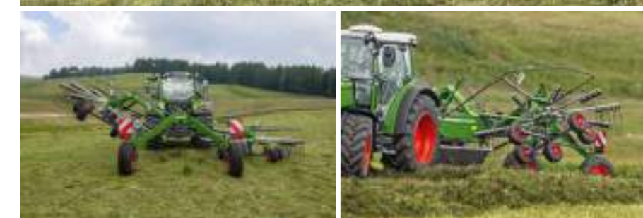
Het zwaddoek klappt in de kopakker- of de transportstand automatisch naar boven.
