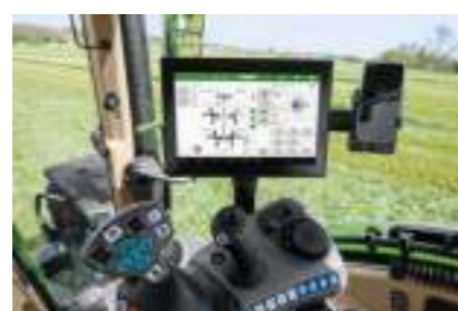
ISOBUS UT: bedieningsschermen kunnen op de tractorterminal worden overgedragen ISOBUS AUX-N: Rijkhendeloverdracht is mogelijk
