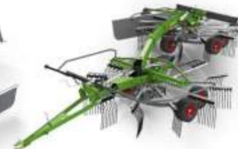
Zijafleg getrokken treintjesmodel Uiterst wendbaar en flexibel met 1- of 2-zwadafleg Werkbreedtes van 6,30 – 7,00 m
