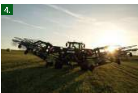
3 Stilstand Alle vier de rotors tillen de tanden op tot boven de ingestelde harkhoogte
