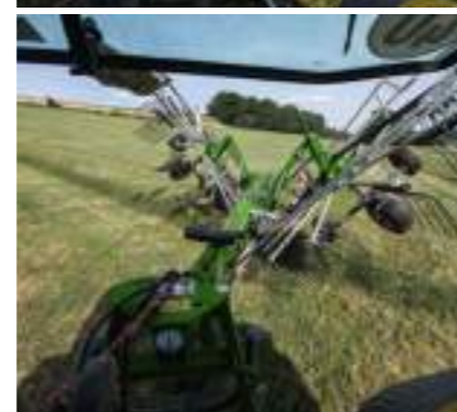
De standaard volgordesturing levert perfecte zwaden op de kopakker en aan de randen en gieren van het veld
