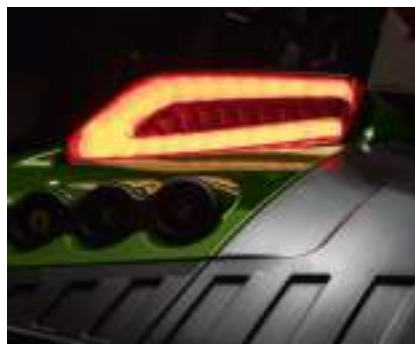
Nieuwe led-achterlichten (CAN-compatibel) met dynamisch knipperlicht
